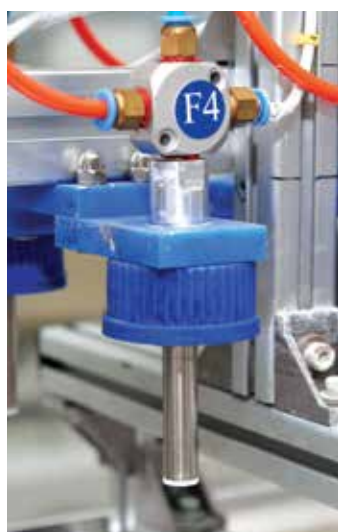
Hình 11. Các thành phần của một hệ cold finger
